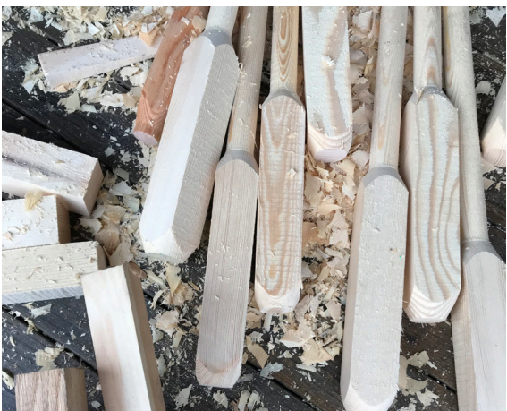
Høsten på Isegran har vært fin. Nederst til høyre vises naglene til prammen. Det kommer til å gå med ca 3000 slike før prammen ligger på vannet.
