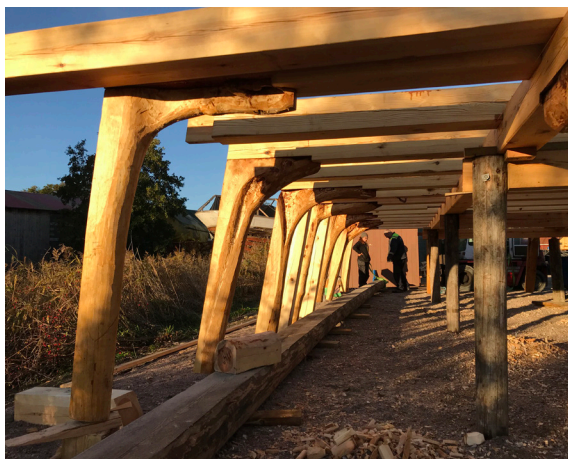
Høsten på Isegran har vært fin. Nederst til høyre vises naglene til prammen. Det kommer til å gå med ca 3000 slike før prammen ligger på vannet.
